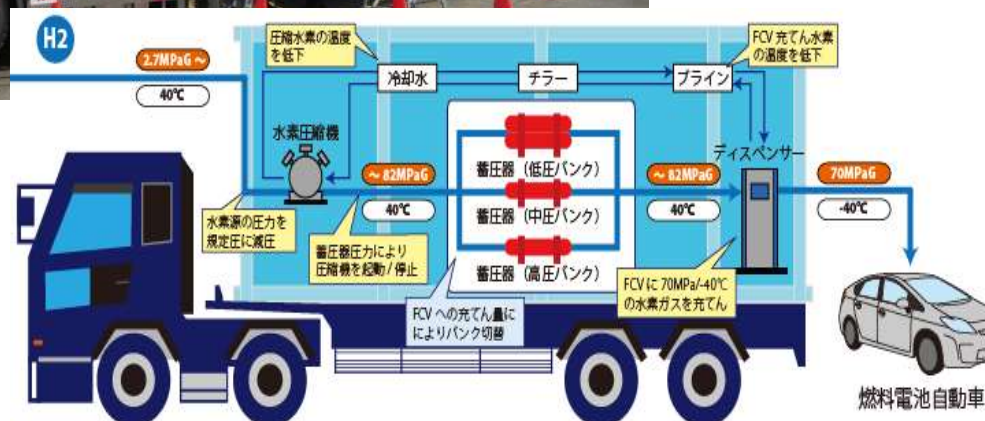
水素ステーション内部詳細
